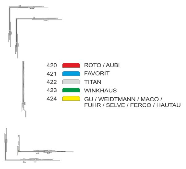
Viele Varianten sind möglich. So kann z.B. eine Eckumlenkung mit verschiedenen Zahnschuhen zum Ankoppeln eines AUBI-Getriebes an eine Winkhaus-Schere realisiert werden. Durch die unterschiedlichen Schenkellängen ist der Austausch oder Einbau fast immer möglich. Mit der gleichschenkeligen Eckumlenkung (153 x153mm) können viele defekte Umlenkungen 1 zu 1 getauscht werden. Evtl. muss am Getriebe oder an der Schere etwas gekürzt werden.
