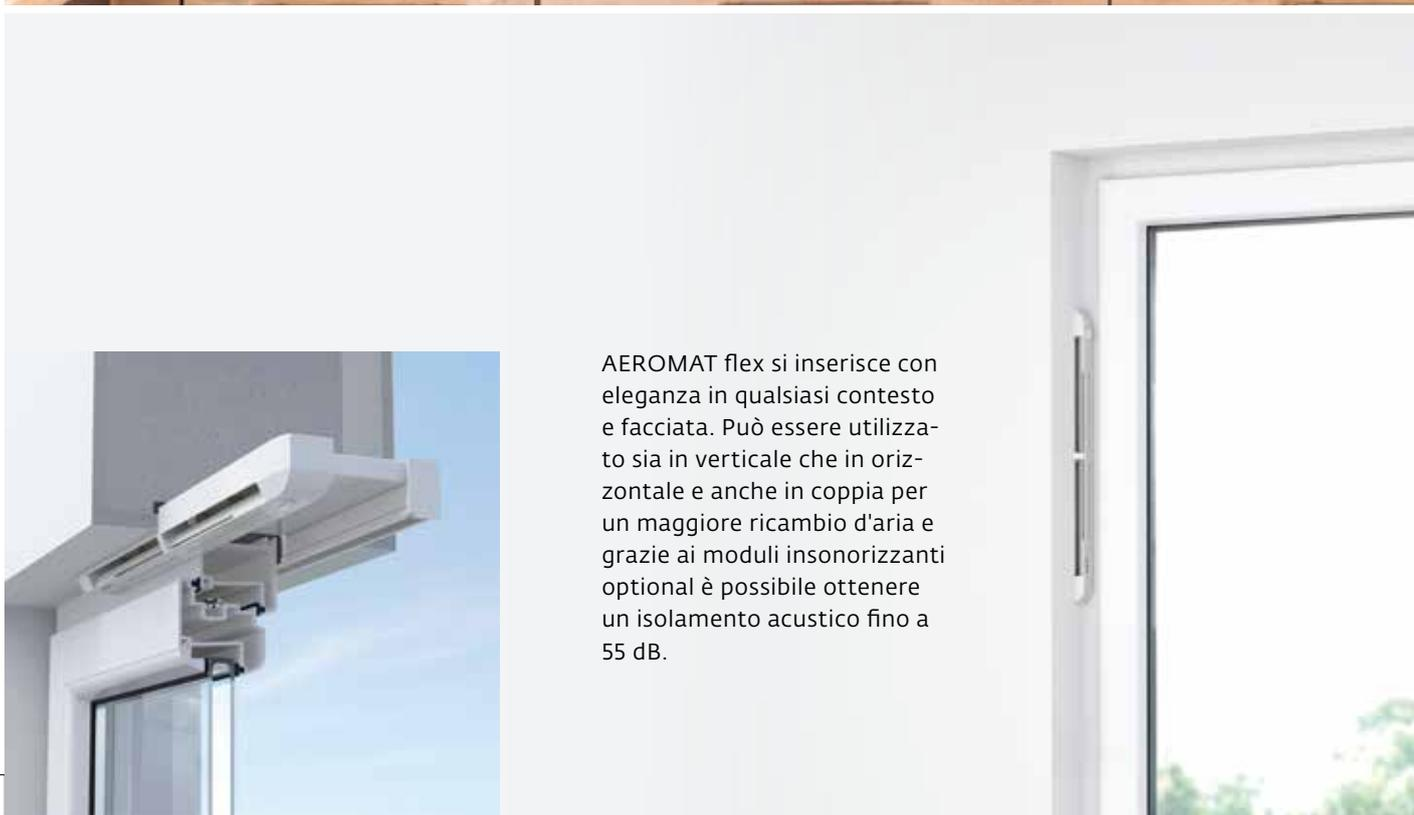
AEROMAT flex si inserisce con eleganza in qualsiasi contesto e facciata. Può essere utilizzato sia in verticale che in orizzontale e anche in coppia per un maggiore ricambio d'aria e grazie ai moduli insonorizzanti optional è possibile ottenere un isolamento acustico fino a 55 dB.
