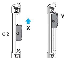
1. Открутите штифт в фиксаторе (X). Передвиньте фиксатор в положение (Y) и прочно зафиксируйте штифтом.
