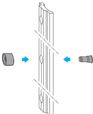
1. Установите с внутренней стороны роликовую цапфу через отверстие тяги и вмонтируйте запорный ролик.
