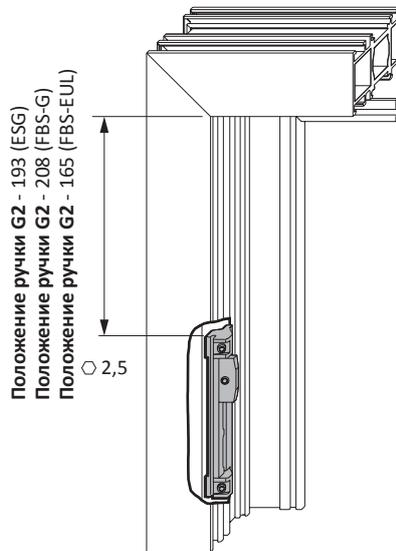
1. Установите скрытолежащий ограничитель поворота согласно указаниям размеров и прочно зафиксируйте штифтами.
