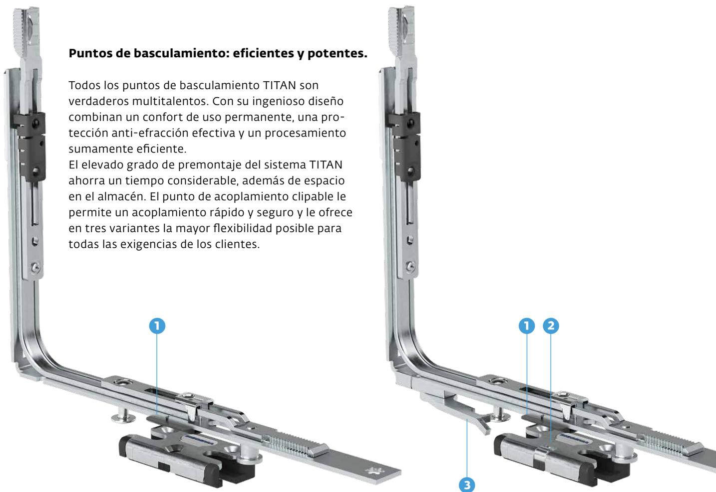
**Punto de basculamiento con patín de hoja integrado 1.** Ya la versión básica establece un elevado estándar. El deslizador siempre se apoya de forma perfecta sobre la barra inferior del marco, compensando así las tolerancias de producción automáticamente. El bulón seta confort autorregulable como perno de cierre contribuye al ajuste óptimo y duradero de la ventana.
