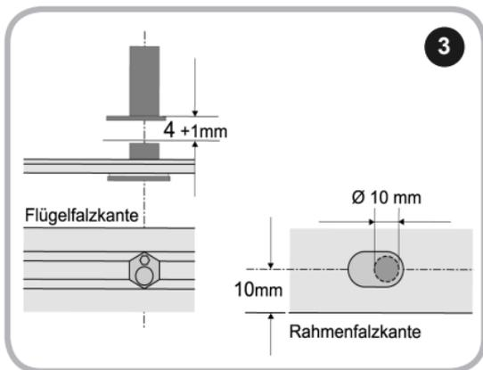
Die Anordnung des Magnetschalters und des Magnetes am Fenster zeigt die Abbildung 2. Die Befestigung erfolgt gleich wie beim Kippfenster.
