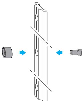
1. Den Rollenzapfen von hinten durch die Bohrung der Schubstange drücken und Schließrolle aufstecken.
