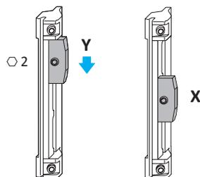
1. Den Gewindestift in der Sperre (Y) lösen. Die Sperre in Position (X) schieben und mit Gewindestift festdrehen.
