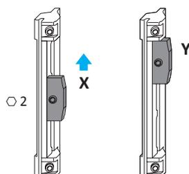
1. Den Gewindestift in der Sperre (X) lösen. Die Sperre in Position (Y) schieben und mit Gewindestift festdrehen.
