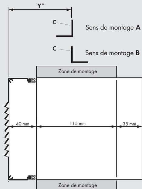
\*Y = profondeur de feuillure moins épaisseur du joint (à l'état monté)
