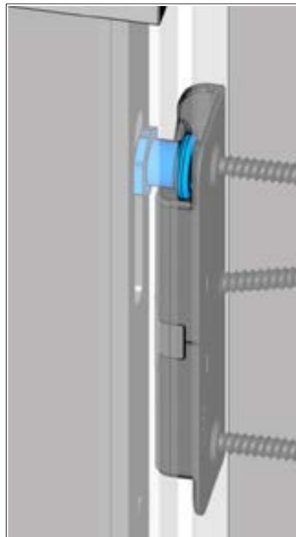
Tijekom vremena može se dogoditi da se list vrata spusti, odn. da se smanjuje putanja pokretanja klinova zbog raspora u mehanici.
