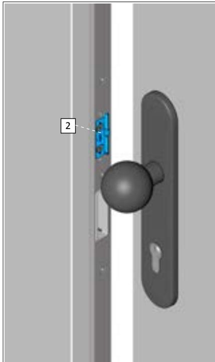
Jezičak [1] služi tome da se vrata drže zatvorenima dok su otključana. Uskače u AT-komad [2] kada su vrata zatvorena. Za otvaranje vrata, pritisne se kvaka [3], odn. okreće se ključ [4] do graničnika u smjeru otključavanja.
