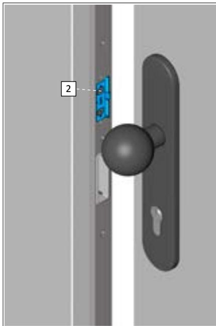
Jezičak [1] služi tome da se vrata drže zatvorenima dok su otključana. Uskače u AT-komad [2] kada su vrata zatvorena. Za otvaranje vrata, pritisne se kvaka [3], odn. okreće se ključ [4] do graničnika u smjeru otključavanja.
